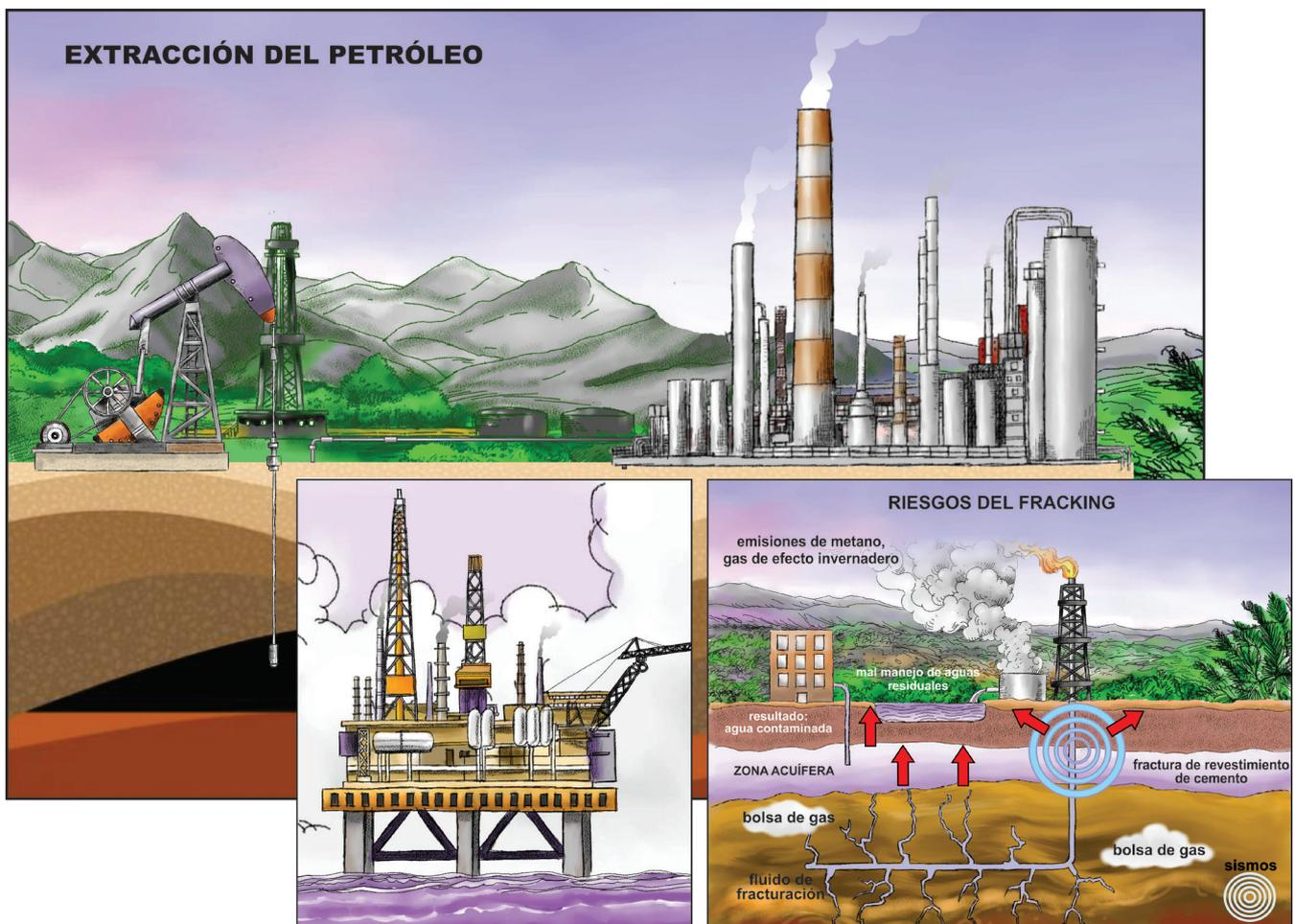
Figura 6. Métodos de extracción del petróleo en tierra y mar (Modificado de R. Cruz Figueroa <http://www.comoves.unam.mx/numeros/articulo/198/fracking-beneficios-fugaces-danos-permanentes>)
