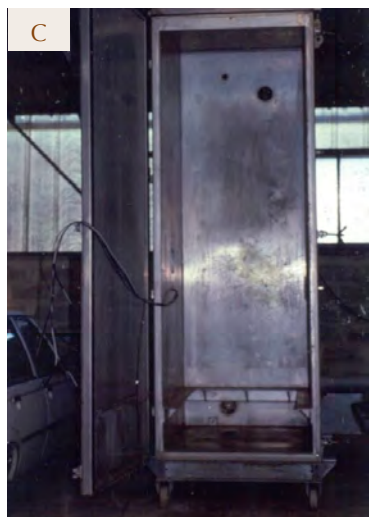
FIGURA 18. Diferentes equipos para la pasteurización de la paja. A: túnel de pasteurización de doble puerta. B: cuarto de pasteurización con el sustrato colocado directamente en el piso. C: pasteurizador metálico móvil y desarmable. D: pasteurizador metálico fijo.
