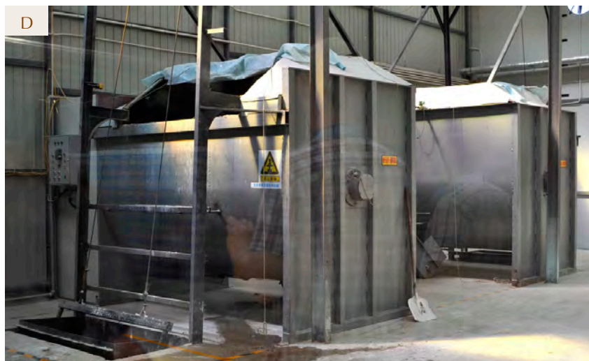
FIGURA 18. Diferentes equipos para la pasteurización de la paja. A: túnel de pasteurización de doble puerta. B: cuarto de pasteurización con el sustrato colocado directamente en el piso. C: pasteurizador metálico móvil y desarmable. D: pasteurizador metálico fijo.
