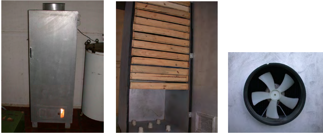
FIGURA 27. Secador de hongos a base de lámparas eléctricas y extractor de aire.
