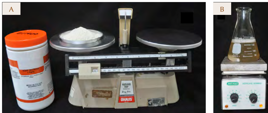
FIGURA 3. Materiales necesarios para la preparación de medio de cultivo a base de agar. A: medio de cultivo comercial. B: disolución, agitación y calentamiento del medio.
