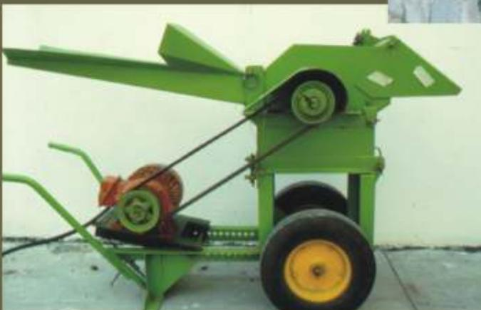
Fig. 20. Picadora eléctrica recomendable para triturar los sustratos.
