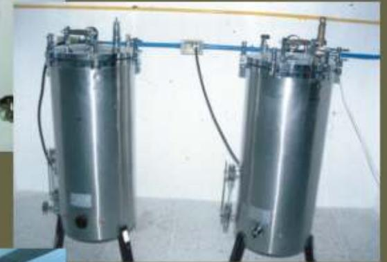
Fig. 5. Autoclaves eléctricas de esterilización.
