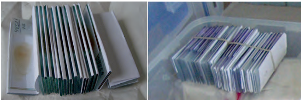
Figura 2.8. Método alternativo para guardar los porta objetos utilizando papel. Una vez que el paquete está hecho se utiliza una liga o cinta adhesiva para mantenerlo cerrado y guardarlo (Foto: Diego Santiago Alarcón).
