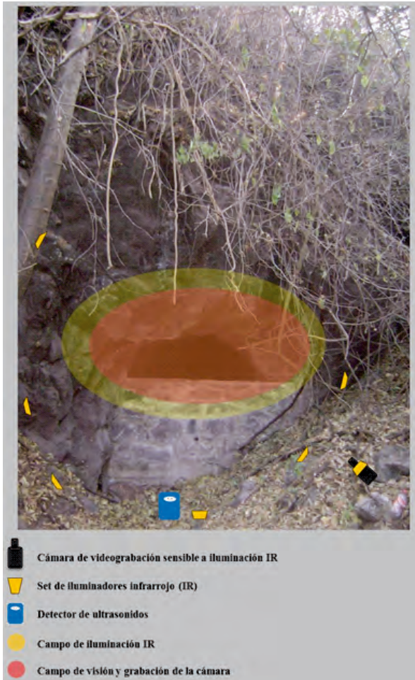
Figura 8.8. Sistema de iluminación, grabación de video y detección acústica simultáneo en un refugio cavernícola.
