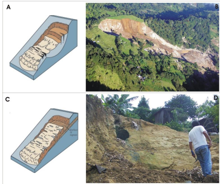
Figura 4. Deslizamientos ( slides ). (A) Dibujo esquemático de deslizamiento rotacional (después de Highland y Johnson, 2004); (B) deslizamiento rotacional en Chiconquiaco, Veracruz (foto cortesía de José Luis Murrieta Hernández), (C) dibujo esquemático de deslizamiento traslacional y (D) deslizamiento traslacional en Los Tuxtlas, Veracruz.
