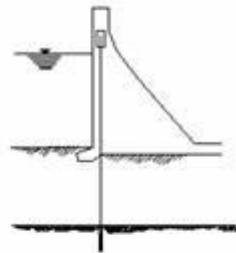
b) Estabilización de una presa de concreto
